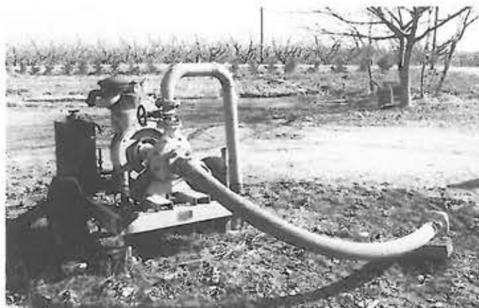
Moto pompe permettant de passer d'un réseau en canaux à une irrigation par aspersion au quartier Caillat
