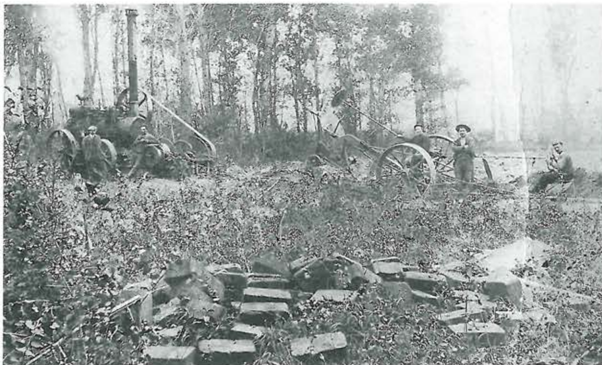
Une routière tirant une charrue défonceuse dite "balance" servant au gros labour et au défrichage. On remarque au premier plan la réserve de briques de charbon pour alimenter la routière
