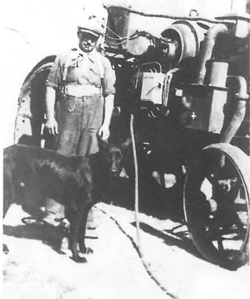
Le tracteur à pétrole de M. Robert équipé d'un moteur électrique pour l'entraînement de la batteuse
